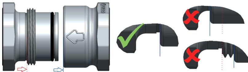
Abb. 20: Ausrichtung prüfen
